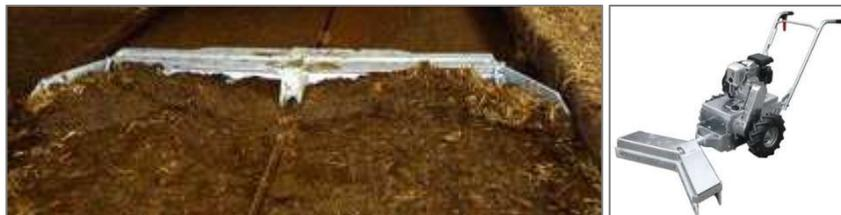
Abbildung 4: Schieber-Entmistungstechnik, Symbolbild, (SUEVIA HAIGES GmbH, 2020) & Spaltenschieber, Symbolbild, (Agro-Widmer Stalleinrichtungen, 2020)
